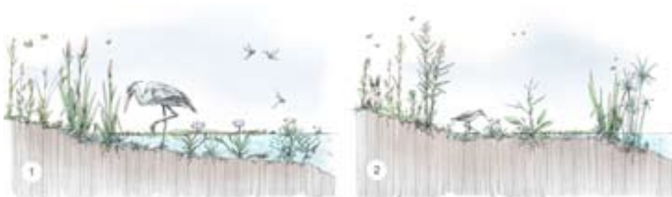
Figuur 1 Natuurvriendelijke oevers zijn er in vele soorten en maten, bijvoorbeeld een plasberm (1) of een drasberm (2).
